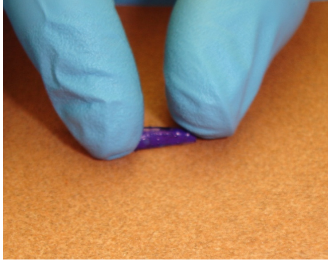
الشكل رقم(2-43): يوضح سحل السطح الداخلي للقالب العاجي باستخدام ورق السحل.
